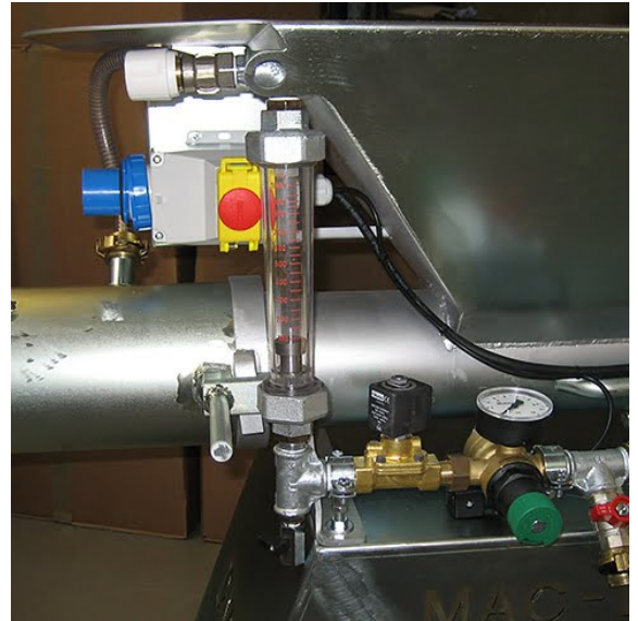
particolare pompa acqua e flussimetro
